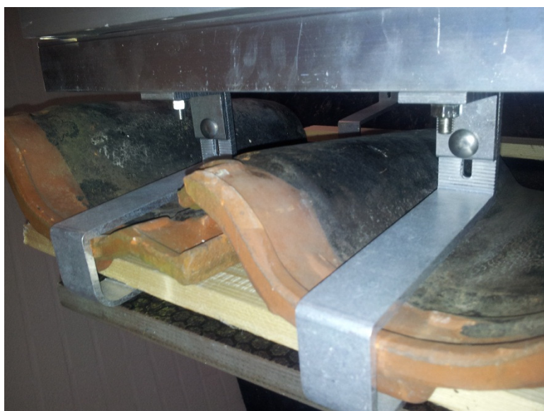
Dakhaken om panlat + onderkant dakpan
